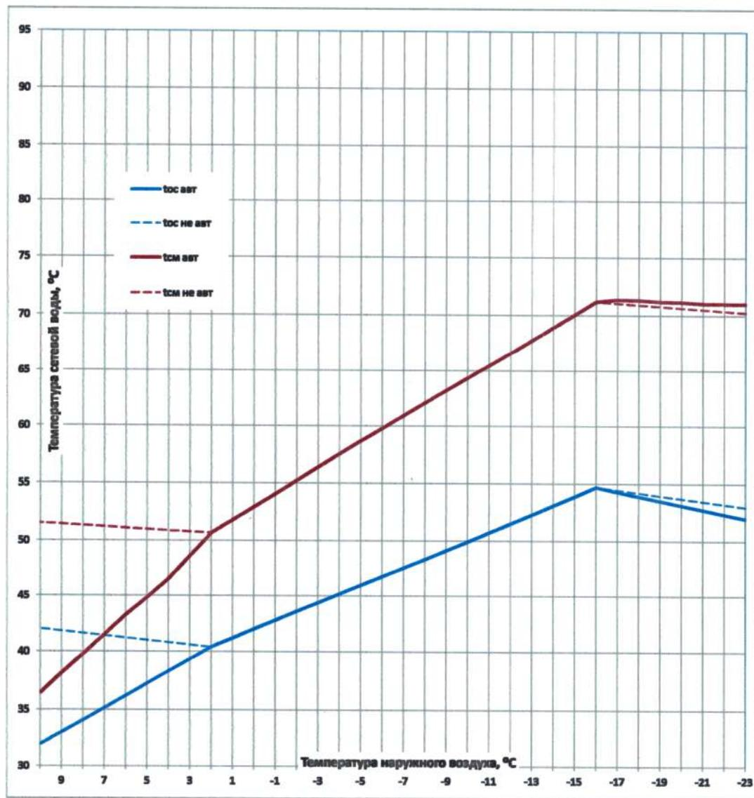
t<sub>cm</sub> не авт - температура прямой сетевой воды, подаваемой в системы отопления не оборудованные САР
